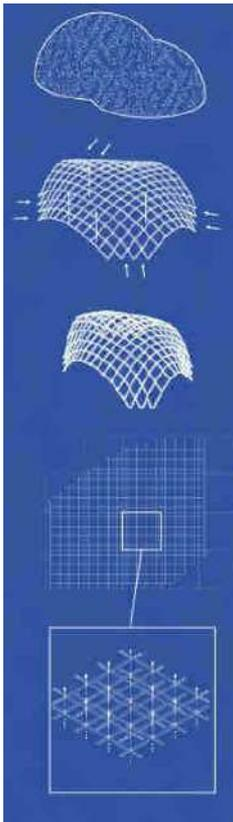
Littéralement, le terme « gridshell » désigne une résille dont le comportement mécanique s'apparente à celui d'une coque. La coque est l'une des formes les plus résistante dans la nature.
